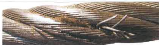
Zerwanie ponad 5% drutów na odcinku równym sześciu średnicom liny lub trzech w tym samym miejscu. Przewężenie lin w dowolnym miejscu o ponad 10%
