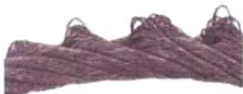
Wypętlone druty i wystawienie rdzenia
