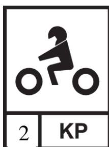
Rysunek 10. Piktogram (szerokość piktogramu powinna wynosić minimum 10 mm), z numerem normy, deklarowanym poziomem ochrony i ochroną kłykci
