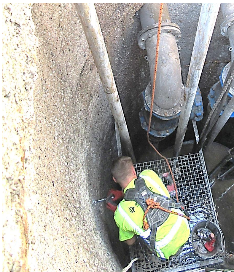
Proces pobieranie próbki rdzeniowej na poziomie około 370cm nad dnem.
