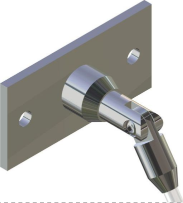
Detal D - mocowanie odciążu do muru
